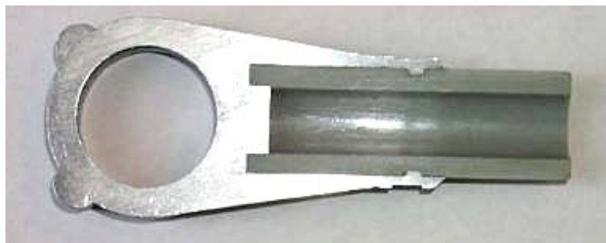
Exempel på infästning av stag mellan ett kompositrör och metalländstycke som ska utvecklas inom CastComp.
